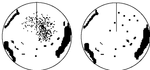
A/C RAIN Regelung ausgeschaltet A/C RAIN Regelung eingestellt A/C RAIN regelt die Empfindlichkeit des Empfängers wie bei A/C SEA, aber über eine längere Zeit.
